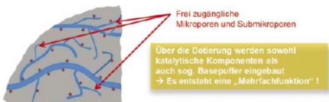
Abb. 5: Porenstruktur der Aktivkohle nach Behandlung mit dem ISDAC-Verfahren (Grafik: Necatec AG)
