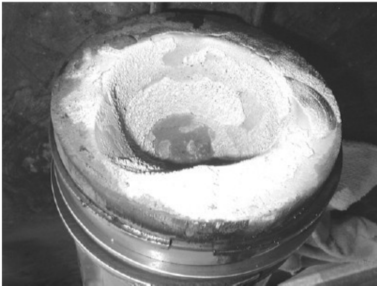
Abbildung 1: Siliziumoxid-Ablagerungen auf einem Gasmotor-Kolben.
